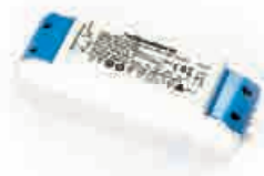
Driver 36a L 141 mm, B 41 mm, H 31 mm Sec.: max. 1500mA, 24V, 36 W dimmbar mit Phasen An und Abschnittdimmer
