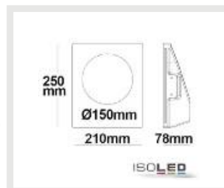
112177 | LED gipsz mennyezetre szerelhető lámpa, GU10, kerek
