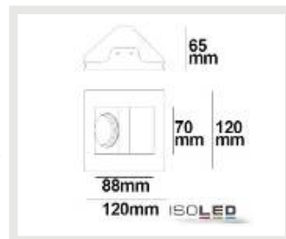
112169 | LED gipsz süllyesztett lámpa, négyszögletes, GU4/MR11,
