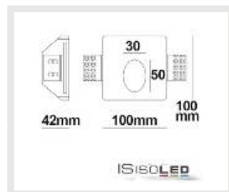
112169 | LED gipsz süllyesztett lámpa, négyszögletes, GU4/MR11,
