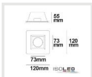
112075 | Süllyesztett gipsz szpotlámpa GU5.3, szögletes, szatinált üveggel, fehér
