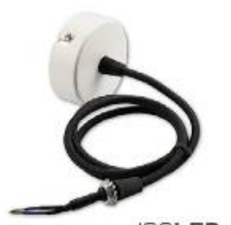
114172 | Mennyezeti rózsa 70mm, kerek, fehér, 2 pólusú szövettel bevont kábel, 1,5 m
