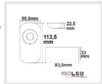
111091 | LED rádiós fényerőszabályozó, 1 csatorna, 12-24V/DC, 8A
